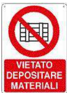
Divieto di depositare materiale in prossimità delle uscite di sicurezza
