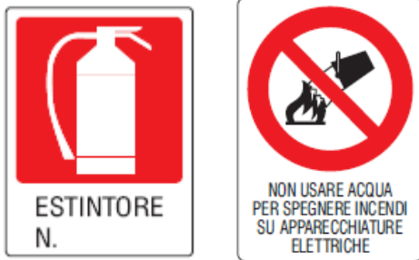
Cartello di segnalazione estintore
